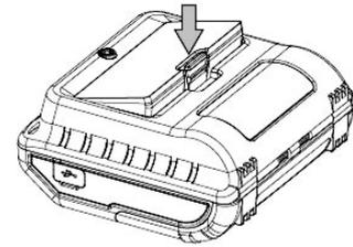
3. Для извлечения батареи потяните за фиксатор крышки батареи и извлеките ее.
